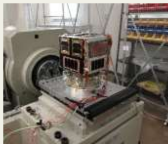
人工衛星の振動試験装置
