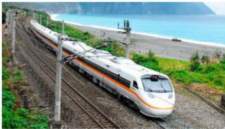
日立が2006年に納入した振り子式特急電車の車両（同社提供）
